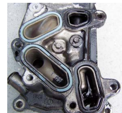
POMPA UKŁADU SMAROWANIA ZANIECZYSZCZONA CZĄSTKAMI WĘGLA
