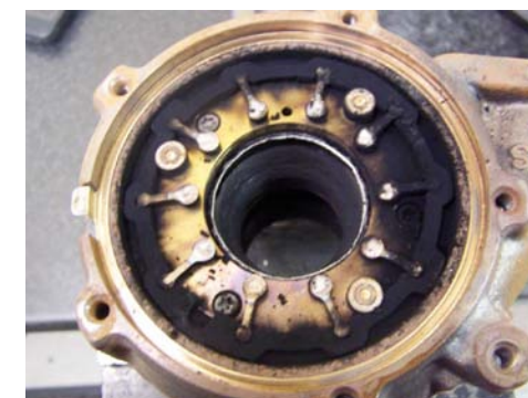
ZABLOKOWANY NAGAREM SYSTEM ZMIENNEJ GEOMETRII ŁOPATEK TURBOSPŘĘŻARKI
