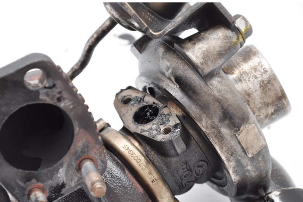
TURBOSPŘĘŻARKA WYMAGAJĄCA KOMPLEKSOWEJ WYMIANY
