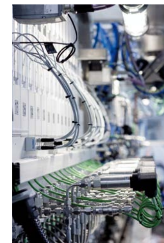
WIELOSTANOWISKOWA STACJA TESTOWANIA I KALIBRACJI WTRYSKIWACZY (Z PRAWEJ: SPRAWDZANIE USTAWIENIA ZAWORÓW)
