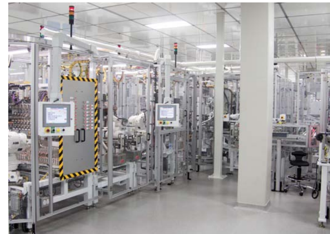
ZAUTOMATYZOWANE STANOWISKO MONTAŻU, SPAWANIA ORAZ TESTU WTRYSKIWACZA
