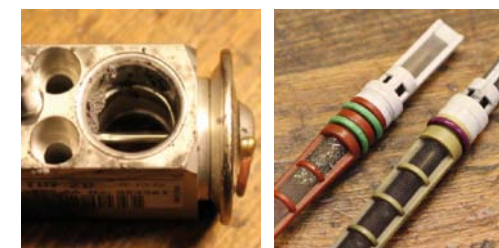
ZAWÓR ROZPRĘŻNY (Z LEWEJ) STOSOWANY W UKŁADACH ALTERNATYWNIE Z DYSZAMI ROZPRĘŻNYMI (Z PRAWEJ)
