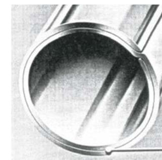
PRZEKRÓJ STALOWEGO PRZEWODU HAMULCOWEGO O PODWÓJNYCH ŚCIANKACH
