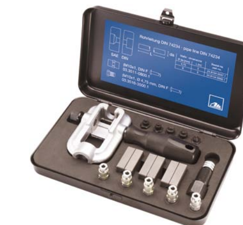
SPECJALNY PRZYZRĄD ATE DO FORMOWANIA PODWÓJNIE ZAGNIATANYCH KOŃCÓWEK PRZEWODÓW O ŚREDNICACH 4,75 MM, 5 MM, 6 MM, 8 MM, A W NIEKTÓRYCH WERSJACH NAWET 10 MM
