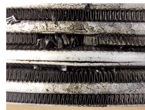
ROZSADZENIE INTERCOOLERA PRZEZ NADMIERNE CIŚNIENIE WEWNĘTRZNE
