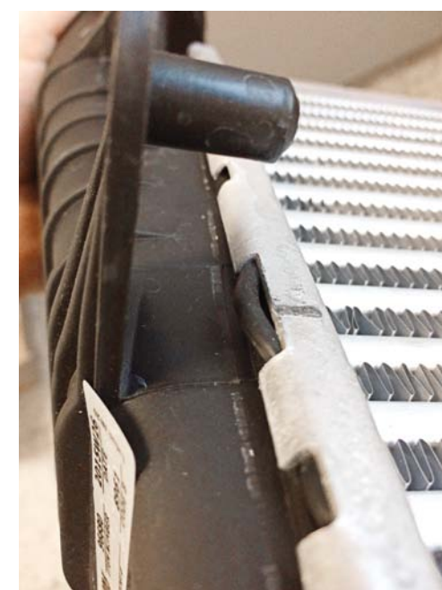
USZKODZENIE PLASTIKOWEGO ZBIORNIKA
