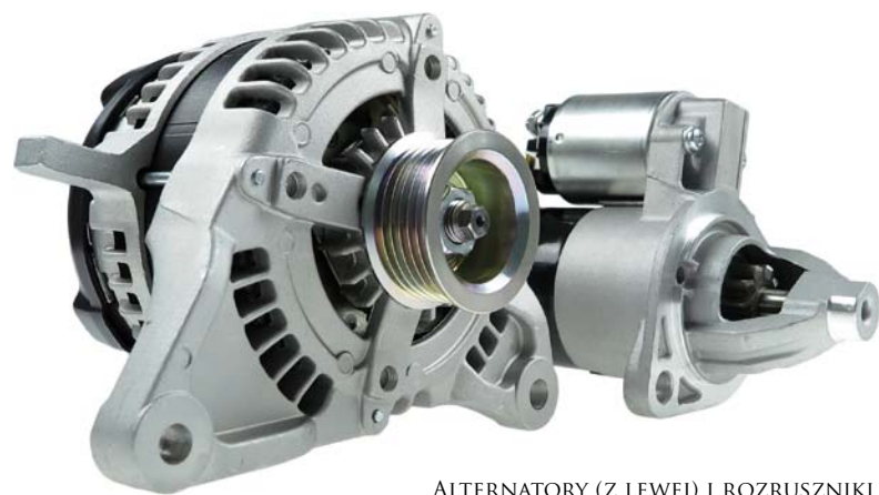
ALTERNATORY (Z LEWEJ) I ROZRUSZNIKI NADAJĄ SIĘ DO PONOWNEGO STOSOWANIA PO PROFESJONALNEJ REGENERACJI
