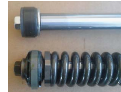
RYS. 2. U GÓRY – TŁOK ORYGINALNY, NIŻEJ – UPROSZCZONY PRZEZ CHIŃSKIEGO PRODUCENTA
