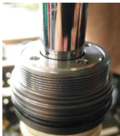
RYŚ. 11. ZAMKNIĘCIE KORPUSU ŻELIWNĄ PROWADNICĄ TŁOCZYSKA PRODUKOWANA PRZEZ FIRMĘ EMMETEC
