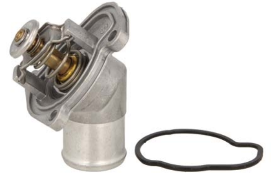
TERMOSTAT ZINTEGROWANY Z KRÓĆCEM PRZYLĄ CZENIOWYM DUŻEGO OBIEGU CHŁODZENIA
