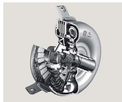
PRZEKRÓJ PRZEKŁADNI ZE SPRZĘGŁEM WIELOPŁYTKOWYM HCC
