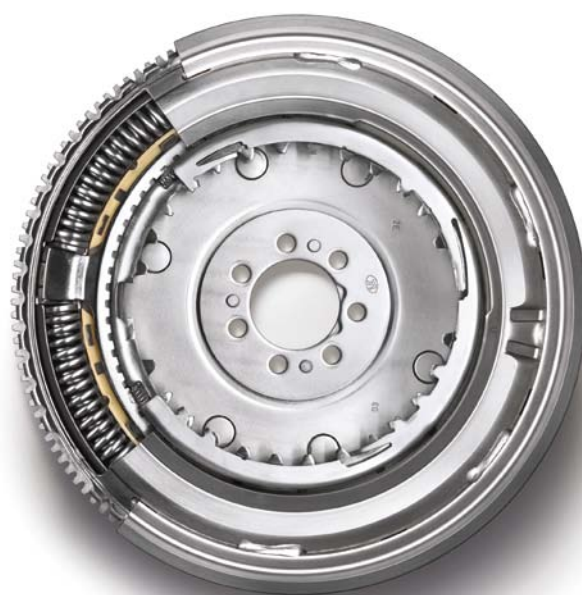
KŁOPOTY Z ELEKTRONICZNĄ ADAPTACJĄ PODWÓJNEGO SPRZĘGŁA MAJĄ PRZEWAŻNIE PRZYCZYNNY MECHANICZNE, NP. NIEODPOWIEDNIĄ LICZBĘ ZĘBÓW NA WIENCIE ROZRUSZNIKA
