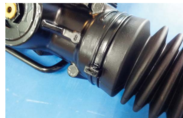
PLASTIKOWYCH OPASEK ZACISKOWYCH NA OSŁONACH GUMOWYCH NIE WOLNO ZDEJMOWAĆ. GDYŻ GROZI TO UTRATĄ GWARANCJI
