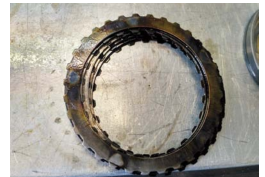
ZANIECZYSZCZENIA ZAWARTE W ZUŻYTYM OLEJU UTRUDNIAJĄ PRAWIDŁOWĄ PRACĘ PRECYZYJNYCH ELEMENTÓW AUTOMATYCZNEJ PRZEKŁADNI
