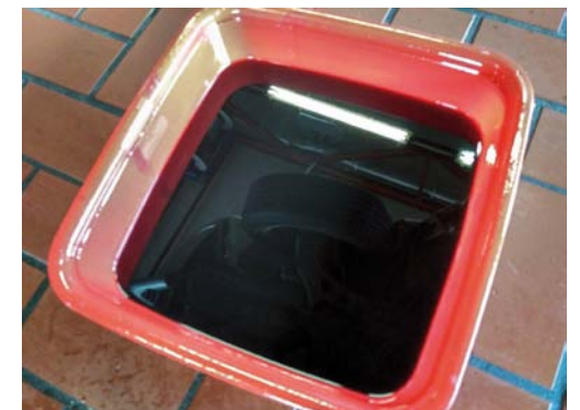
METODĄ STATYCZNĄ WYMIENIĆ MOŻNA NAWYŻEJ 40 DO 60% ZUŻYTEGO OLEJU ZNAJDUJĄCEGO SIĘ W SKRZYNI
