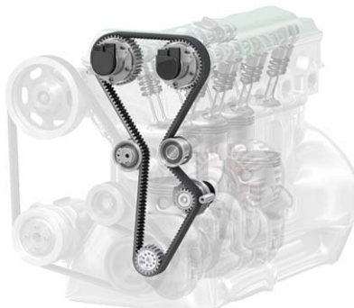
DLA ODPOWIEDNIEGO ZAZĘBIENIA I UNIKNIĘCIA POŚLIZGU STOSUJE SIĘ KOŁA ZĘBATE NA WALE KORBOWYM ORAZ WAŁKU ROZRZĄDU
