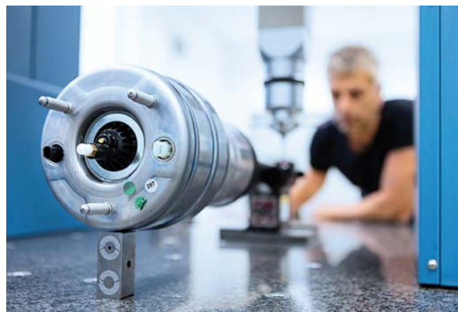
ZINTEGROWANE KOLUMNY ZAWIESZEŃ PNEUMATYCZNYCH BILSTEIN NA KOŃCU FABRYCZNEJ TAŚMY MONTAŻOWEJ (Z LEWEJ) I W TRAKCIE KOŃCOWEJ KONTROLI TECHNICZNEJ
