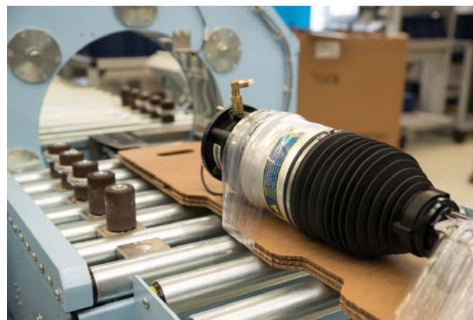
ZINTEGROWANE KOLUMNY ZAWIESZEŃ PNEUMATYCZNYCH BILSTEIN NA KOŃCU FABRYCZNEJ TAŚMY MONTAŻOWEJ (Z LEWEJ) I W TRAKCIE KOŃCOWEJ KONTROLI TECHNICZNEJ
