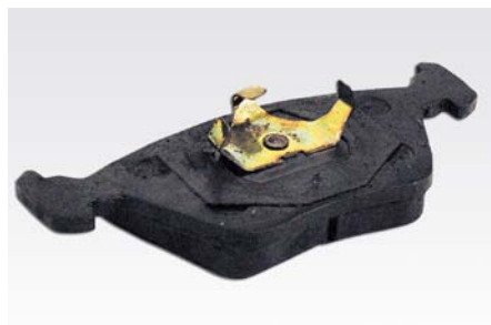
USZKODZENIE SPRĘŻYSTEGO ZACZĘPU PODCZAS NIEPRAWIDŁOWEGO MONTAŻU
