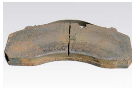
ZANIECZYSZCZENIE KLOCKA HAMULCOWEGO PO SEZONIE ZIMOWYM
