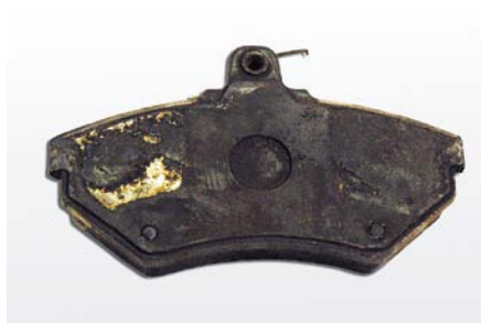
ROZWARSTWIENIE OKŁADZINY CIERNEJ Z POWODU PRZECIĄŻEŃ TERMICZNYCH
