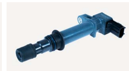
POJEDYNCZE CEWKI „OŁÓWKOWE” OSADZANE BEZPOŚREDNIO NA ŚWIECY ZAPŁONOWEJ
