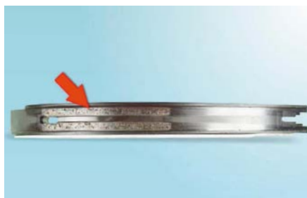
UBYTKI MATERIAŁU METALOWEJ PROWADNICY
