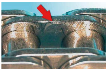
CHARAKTERYSTYCZNE WEWNĘTRZNE I ZEWNĘTRZNE OTARCIA PŁYTEK
