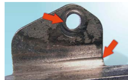
DEFORMACJA OTWORU MOCUJĄCEGO PROWADNICY
