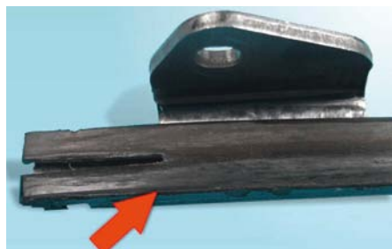
SKRAJNE ŻUŻYCIE ŚLIZGU PROWADNICY METALOWEJ
