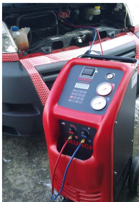
OBSŁUGA SERWISOWA MOŻLIWA JEST PO PRZYŁĄCZENIU PRZEWODÓW CIŚNIENIOWYCH STACJI DO PUNKTÓW SERWISOWYCH UKŁADU W POJEŹDZIE
