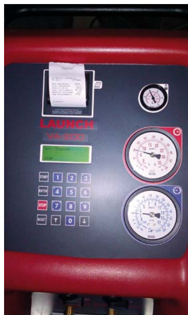
STANDEM AUTOMATYCZNYCH STACJI SERWISOWYCH JEST BAZA DANYCH PARAMETRÓW I WBUDOWANA DRUKARKA
