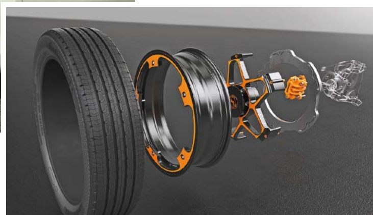
ELEMENTY NOWEJ KONSTRUKCJI KOMPLETNEGO KOŁA
