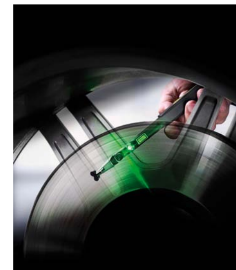
LASEROWE SKANOWANIE POWIERZCHNI CIERNEJ TARCZY
