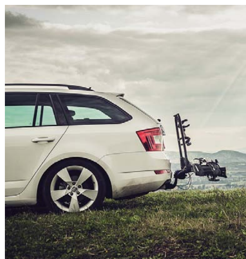
HAKI HOLOWNICZE SŁUŻĄ NIE TYLKO DO POŁĄCZEŃ SAMOCHODÓW Z PRZYCZEPAMI, LECZ TAKŻE DO MOCOWANIA PORĘCZNYCH BAGAŻNIKÓW, NP. ROWEROWYCH
