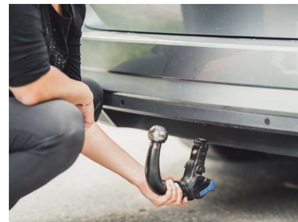
W NOWOCZESNYCH HAKACH HOLOWNICZYCH DOMINUJĄ KONSTRUKCJE ROZBIERALNE
