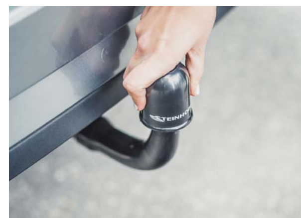
KULA MUSI BYĆ CHRONIONA PRZED ZANIECZYSZCZENIAMI I KOROZJĄ
