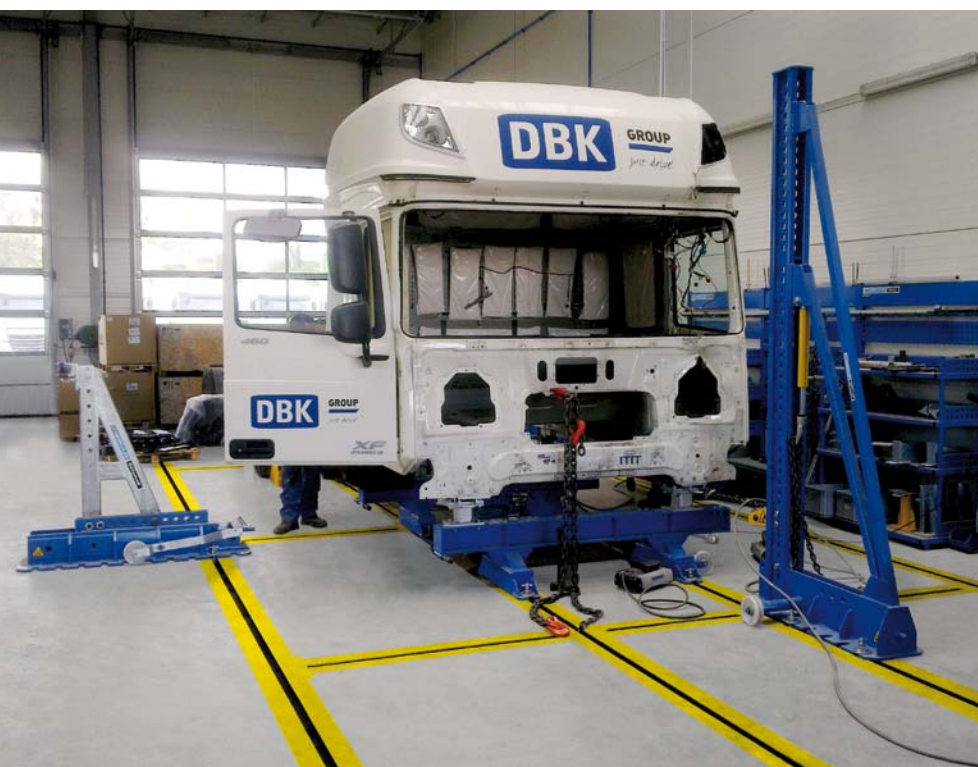
ZDEMONTOWANA KABINA CIĄGNIKA SIÓDŁOWEGO NA OSOBNYM STANOWISKU NAPRAWCZYM. Z PRAWY OD GÓRY: PROSTOWANIE FRAGMENTU RAMY I PODGRZEWANIE OBSZARU DEFORMACJI
