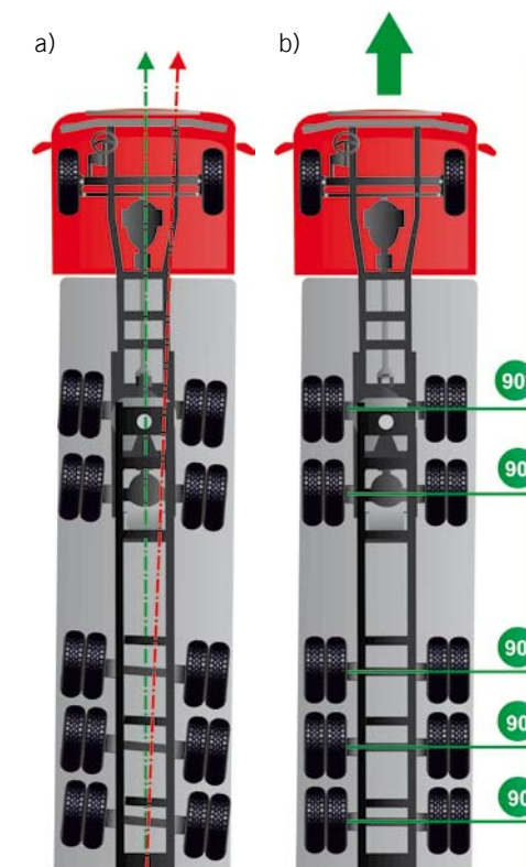
GEOMETRIA CIĄGNIKA SIÓDŁOWEGO Z NACZEPĄ: A) NAPRAWA NIEPRAWIDŁOWA, B) NAPRAWA PRAWIDŁOWA
