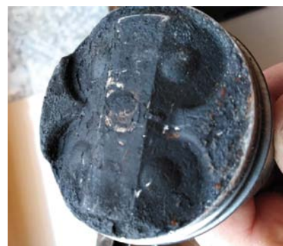
NAGAR NA TŁOKACH I PIERSIENIACH DAJĄCY SIĘ USUWAĆ CHEMICZNIE
