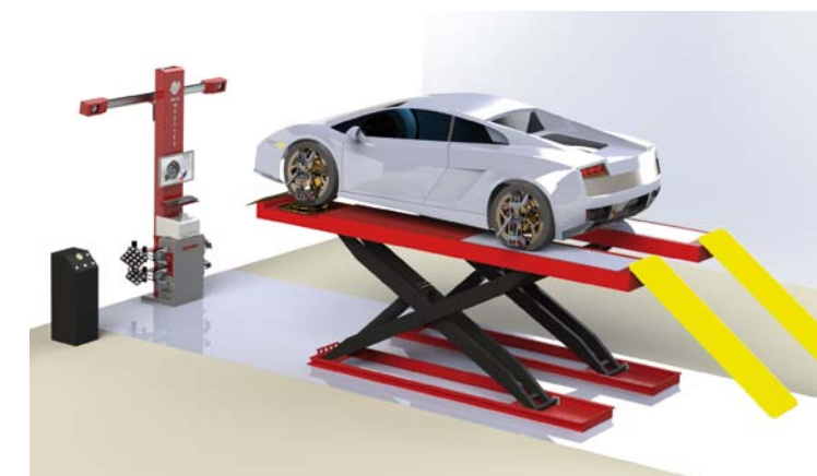
RYS. 3. STANOWISKO Z PODNOŚNIKIEM NOŻYCOWYM (WERTHER)
