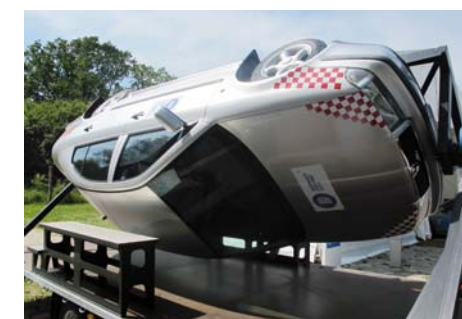
ZNAJDUJĄCE SIĘ W KABINIE GUMOWE PIĘKI SYMULOWAŁY ZACHOWANIE MAŁYCH PRZEDMIOTÓW PODCZAS DACHOWANIA
