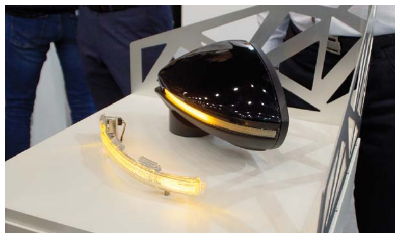
DYNAMICZNY KIERUNKOWSKAZ LEDRIVING Z HOMOLOGACJĄ ECE PRODUKOWANY PRZEZ FIRMĘ OSRAM
