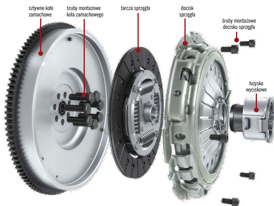
RYS. 1. BUDOWA SPRZĘGŁA K4P
