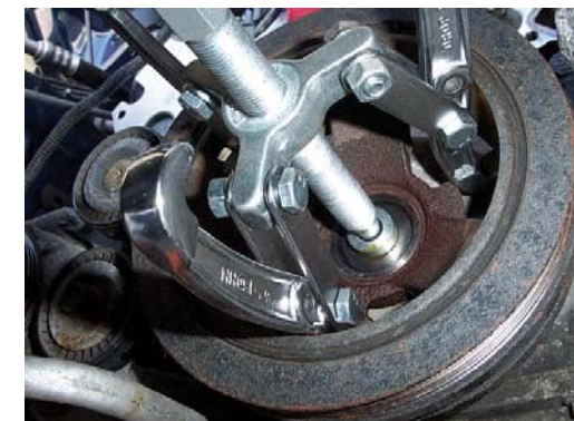
DEMONTAŻ I MONTAŻ KOŁA PASOWEGO NA WALE KORBOWYM WYMAGAJĄ STARANNOŚCI I UŻYCIA ODPOWIEDNIH NARZĘDZI
