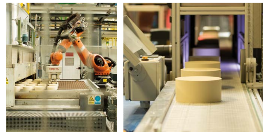
ZAUTOMATYZOWANA LINIA PRODUKCJI BŁOKÓW KATALITYCZNYCH
