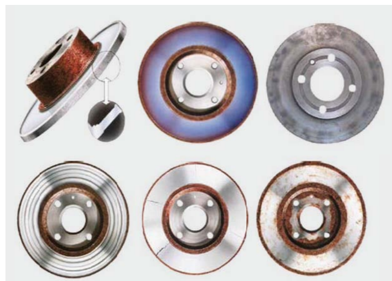
FOT. 1. USZKODZENIA TARCZ HAMULCOWYCH
