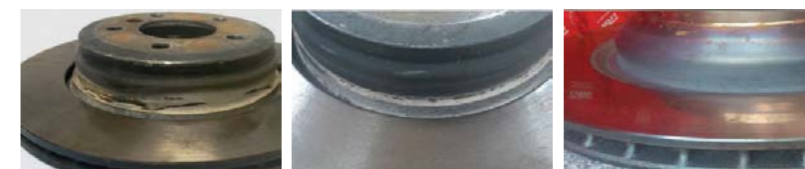
FOT. 2. RÓŻNE TYPY TARCZ PRZEGRZANE W OKOLICY TZW. DZWONA
