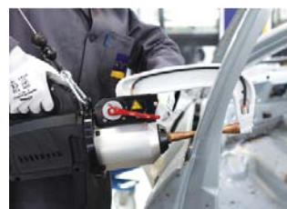
ZGRZEWANIE KAROSERII URZĄDZENIEM O BARDZO WYSOKICH PARAMETRACH Z AUTOMATYCZNYM DOBÓREM PARAMETRÓW PRACY (GYS.PL)
