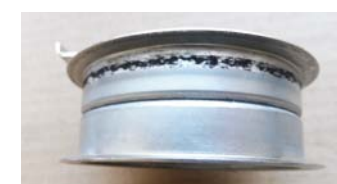
FOT. 5 POZOSTAŁOŚCI PASKA NA ROLCE NAPINAJĄCEJ
