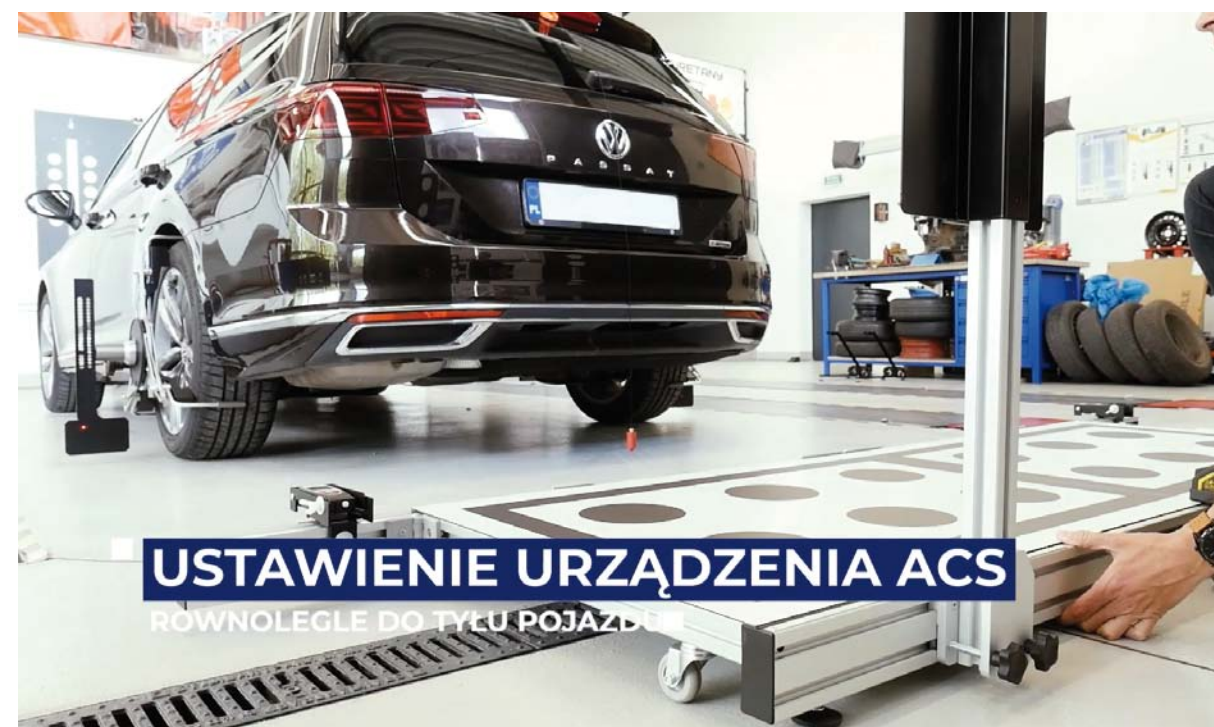
RYS. 1. USTAWIANIE URZĄDZENIA TEXA ACS ZGODNIE Z INSTRUKCJĄ DOSTĘPNĄ W OPROGRAMOWANIU
