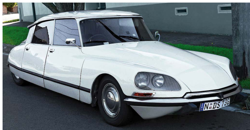
Citroën DS 19 z nowymi, kierunkowymi reflektorami doświetlającymi zakręty, wprowadzonymi w 1968 roku w ramach jednej z wielu modernizacji
