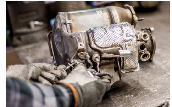
ZDEMONTOWANY FILTR CZĄSTEK STAŁYCH POJAZDU OSOBOWEGO
