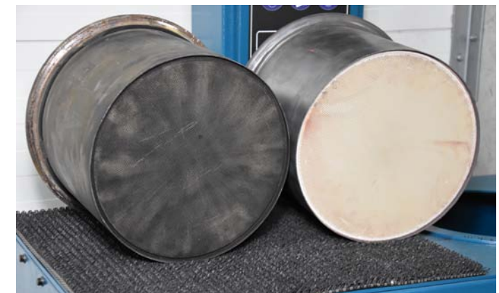
FILTR SAMOCHODU CIĘŻAROWEGO PRZED I PO REGENERACJI
