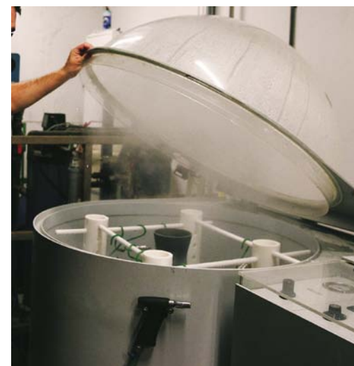
TEST W SOLANCE POZWALA SPRAWDZIĆ ODPORNOŚĆ ZACISKU HAMULCA POSTOJOWEGO NA KORÓZJĘ
