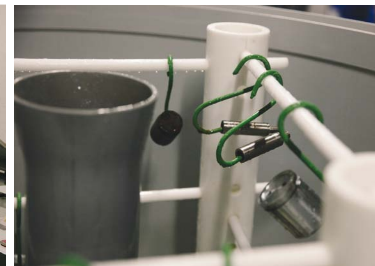
TEST W SOLANCE POZWALA SPRAWDZIĆ ODPORNOŚĆ ZACISKU HAMULCA POSTOJOWEGO NA KORÓZJĘ
