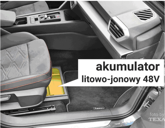
RYS 10. UMIEJSCOWIENIE AKUMULATORA TRAKCYJNEGO UKŁADU MIKROHYBRYDY
