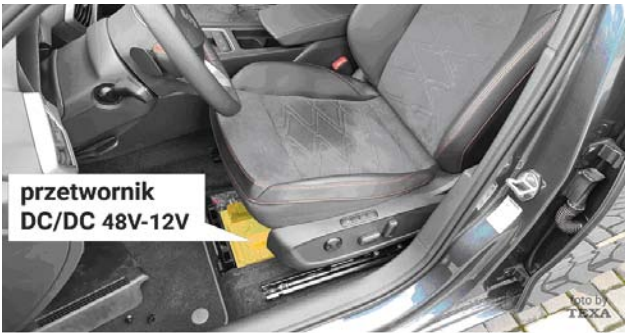
RYS 7. ROZMIESZCZENIE KOMPONENTÓW UKŁADU MIKROHYBRYDOWEGO – PRZETWORNIK DC/DC
