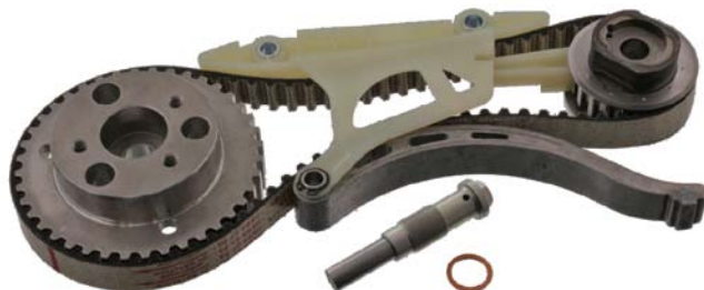
RYS. 2. PRZEKŁADNIA PASOWA FEBI 46380 WYKORZYSTYWANA DO NAPĘDU POMPY WYSOKIEGO CIŚNIENIA PALIWA SILNIKÓW FORD 1.8 TDCI LYNX/DURATORQ.
