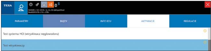
RYS. 1. AKTYWACJA TESTU WTRYSKIWACZY W OPROGRAMOWANIU IDC5 TEXA
