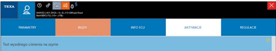
RYS. 3. AKTYWACJA TESTU WYSOKIEGO CIŚNIENIA NA SZYNIE W OPROGRAMOWANIU IDC5 TEXA.
