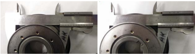
RÓŻNICA ŚREDNIC OWALNEGO KOŁA WAŁU KORBOWEGO WYNOŚI JEDYNNIE 2 MM
