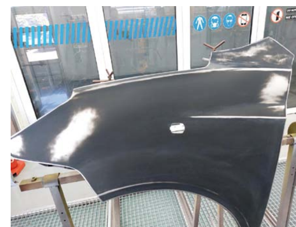
PRZYGOTOWANY DO GRUNTOWANIA ELEMENT ZMATOWANY I ODTŁUSZCZONY ZMYWACZEM CP015
