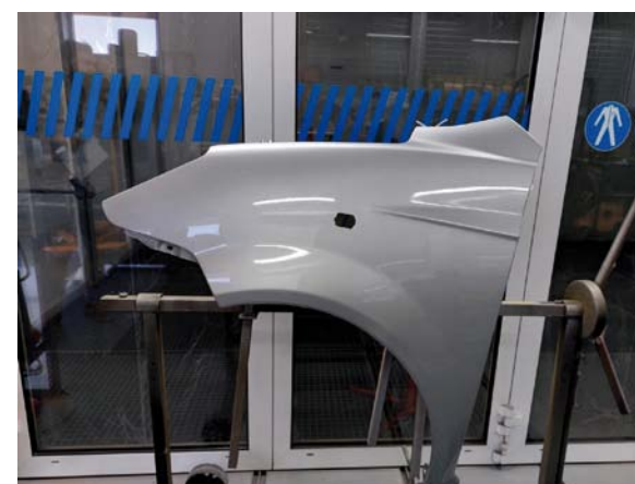
KOMPLETNA POWŁOKA Z BAZĄ WODOROZCIEŃCZALNĄ AQUA 2G I BEZBARWNYM CP2016
