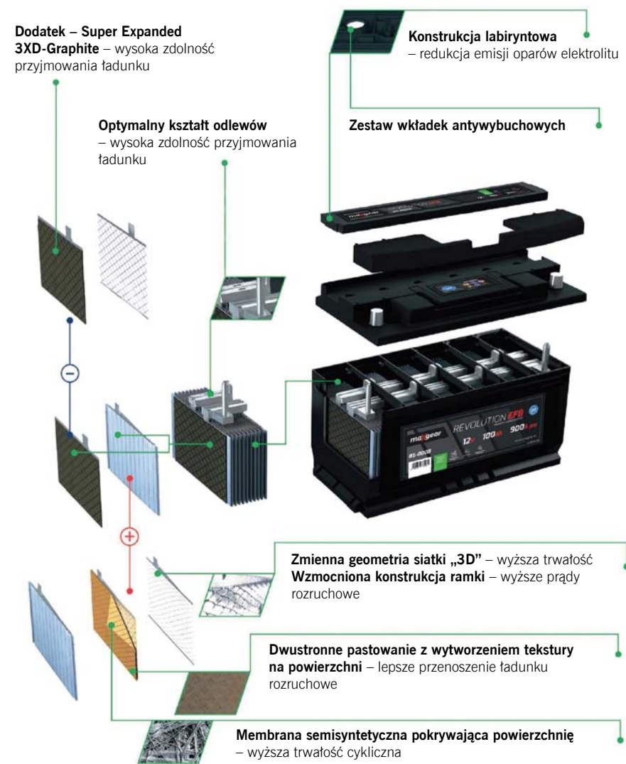
KONSTRUKCJA AKUMULATORA EFB
