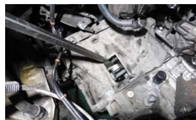
ZATRZAŚNIĘCIE ŁOŻYSKA W DOCISKU PO MONTAŻU SKRZYNI BIEGÓW
