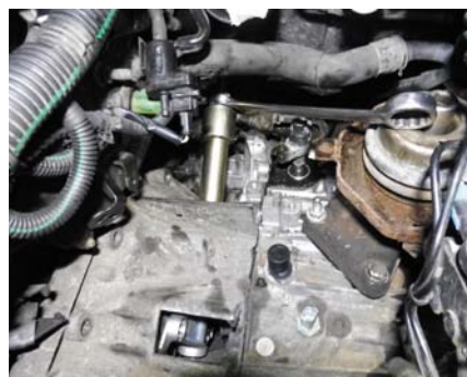
WYPRASOWYWANIE TRZPIENIA WIDEŁEK
