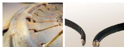
Z LEWEJ: OCIERANIE SPRĘŻYNY TALERZOWEJ O OBUDOWĘ DOCISKU. Z PRAWEJ: ZUŻYTY PIERŚCIEŃ OSADCZY
