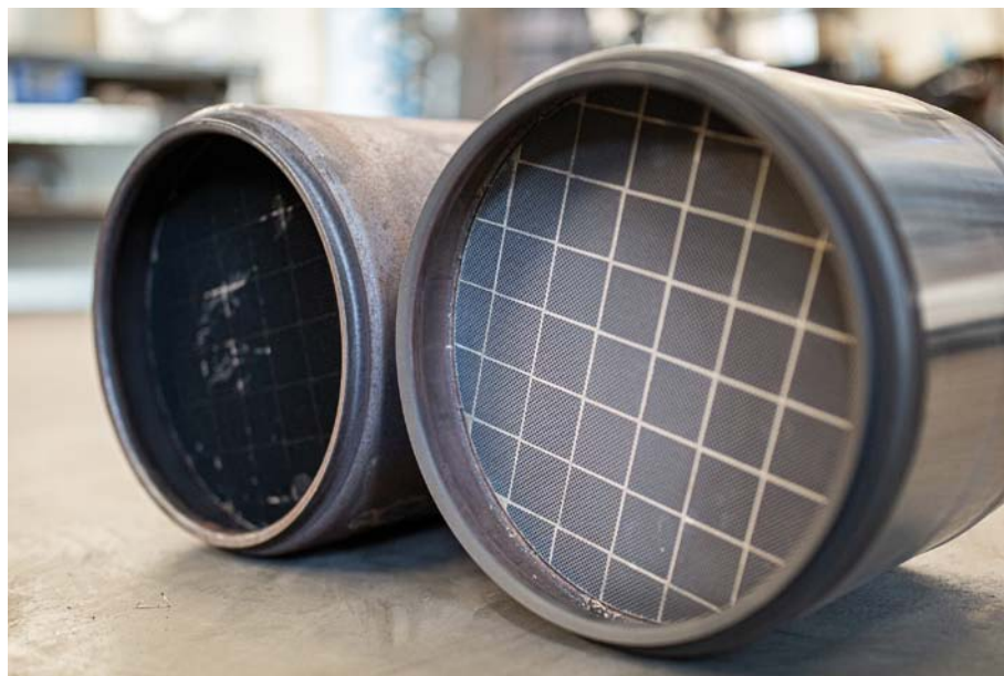
FILTR SAMOCHODU CIĘŻAROWEGO PRZED I PO REGENERACJI
