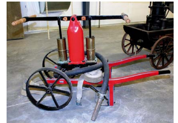
RĘCZNY WÓZ STRAŻACKI NEWSHAM Z 1725 ROKU OBSŁUGIWANY PRZEZ 12 MĘŻCZYZN (Z LEWEJ) I MAŁA, PRZYPOMINAJĄCA TACZKĘ, DWUCYLINDROWA POMPA Z 1880 ROKU. DWÓCH LUB CZTERECH MĘŻCZYZN POMPOWAŁO NIĄ OK. 100 LITRÓW NA MINUTĘ. WODĘ DONOSIŁA WIADRAMI BRYGADA KUBEŁKOWA
