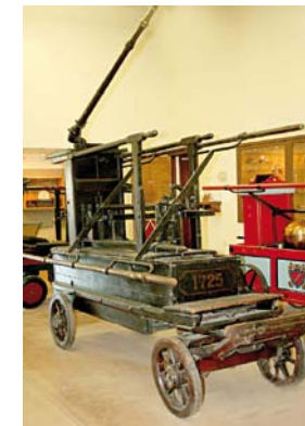
RĘCZNY WÓZ STRAŻACKI NEWSHAM Z 1725 ROKU OBSŁUGIWANY PRZEZ 12 MĘŻCZYZN (Z LEWEJ) I MAŁA, PRZYPOMINAJĄCA TACZKĘ, DWUCYLINDROWA POMPA Z 1880 ROKU. DWÓCH LUB CZTERECH MĘŻCZYZN POMPOWAŁO NIĄ OK. 100 LITRÓW NA MINUTĘ. WODĘ DONOSIŁA WIADRAMI BRYGADA KUBEŁKOWA
