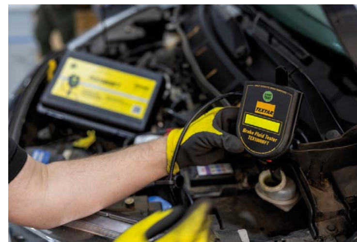
NAJLEPSZYM SPOSOBEM WERYFIKACJI STOPNIA ZUŻYCIA PŁYNU HAMULCOWEGO JEST UŻYCIU TESTERA. NA ZDJĘCIU TESTER TEX1000BFT
