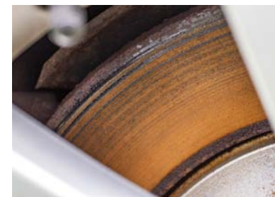
PRZYSPIESZONA KOROZJA TARCZ HAMULCOWYCH STANOWI NAJCZĘŚCIEJ WYSTĘPUJĄCY PROBLEM W POJAZDACH ELEKTRYCZNYCH
