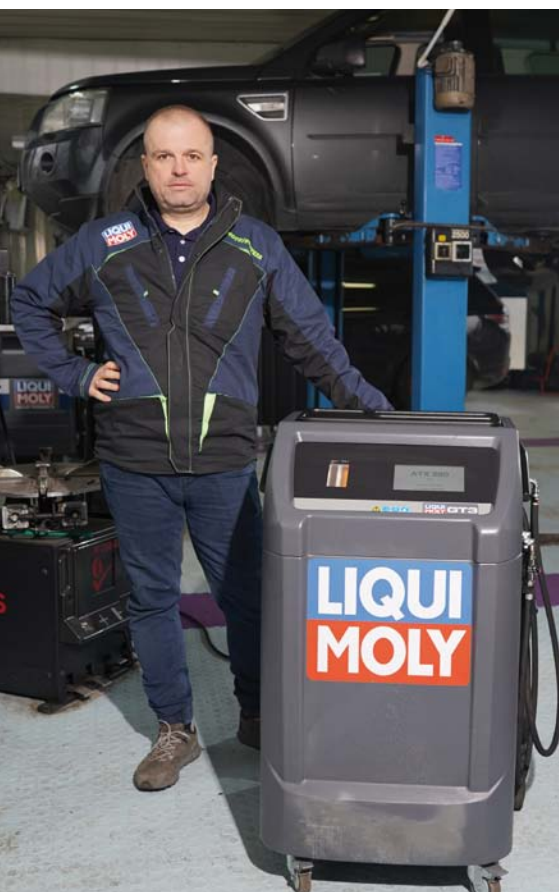
AUTOR PREZENTUJE URZĄDZENIE DO DYNAMICZNEJ WYMIANY OLEJU W AUTOMATYCZNYCH SKRZYNIACH BIEGÓW – LIQUI MOLY GT3
