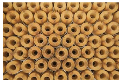
OBUDOWY FILTRÓW PUSZKOWYCH POCHODZĄ Z WŁASNEJ PRODUKCJI PZL SĘDZISZÓW, A MATERIAŁY FILTRACYJNE WYTWARZANE SĄ PRZEZ RENOMOWANYCH ZACHODNICH PRODUCENTÓW
